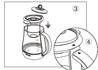
2. 玻璃炖盅拆卸：①提起支架连炖盅一起取出，②轻轻放下支架，③拿走支架外盖，取出炖盅。
