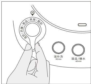
此款电水壶有两种方法使用炖功能旋钮，启动对应炖功能。
